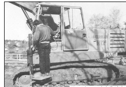
Alla styrfunktioner är handmanövrade i Stens förarhytt.
