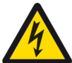
Farlig elektrisk spänning
